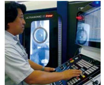
5軸制御超音波加工機
