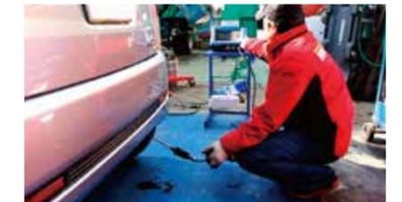
排気ガステストでの測定
