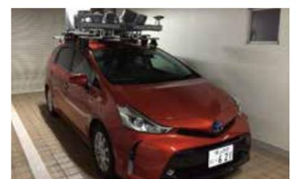
移動計測車両測量システム (MMS)
