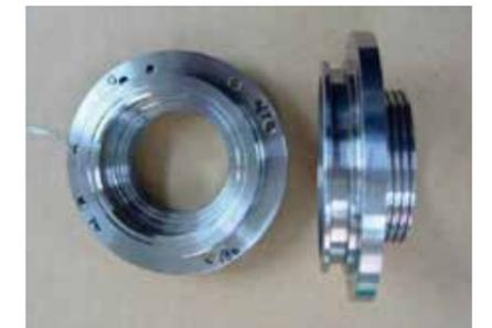
旋削加工工程を経た製品
