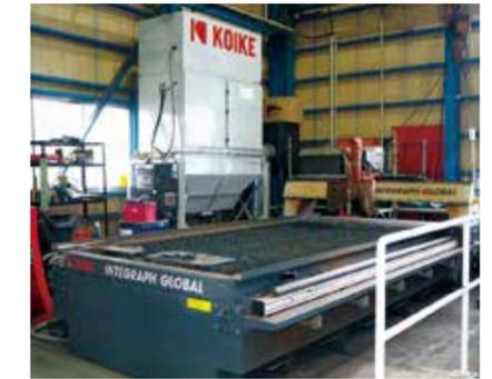
導入した定盤一体型プラズマ切断機
