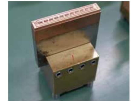
電極(コネクタ用金型部品の製作ツール)
