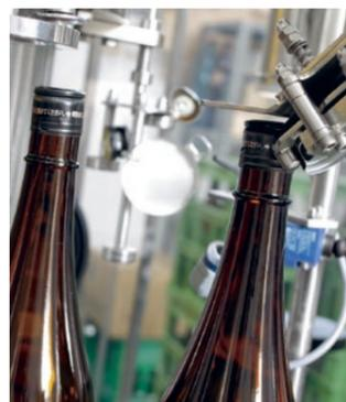
手詰め作業の場合、充填口が囲われないため、異物混入のリスクが高く、瓶の抜き差し時に液漏れが生じることがありました。そのためカビの発生にもつながりやすいリスクがありました。加
