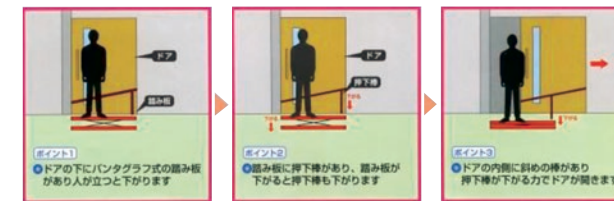
テコの原理で開閉するため電気を一切使わない
