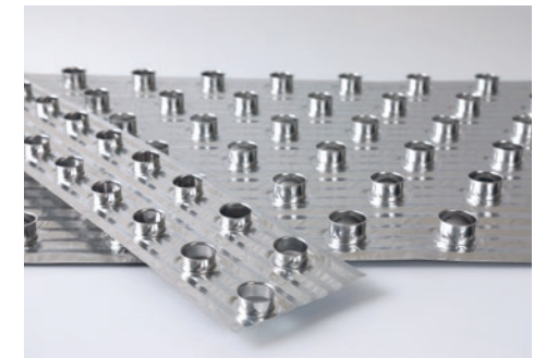
ハイカラーコンビネーション金型での試作品
