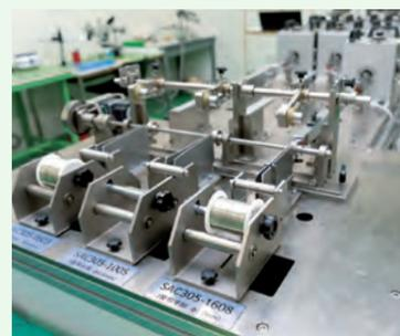
本事業で導入した「はんだプリフォーム作成機」で製造する新しい半田プリフォームは、「チップ型はんだアシスト」として製品化。電子部品関連の展示会などでのPR活動も功を奏し、今では毎日約30万個使っていただくまでに成長。市場で高い評価を獲得しています。
