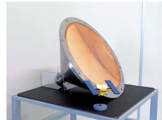
小惑星探査機「はやぶさ2」の衝突装置(インパクター)の複製品
