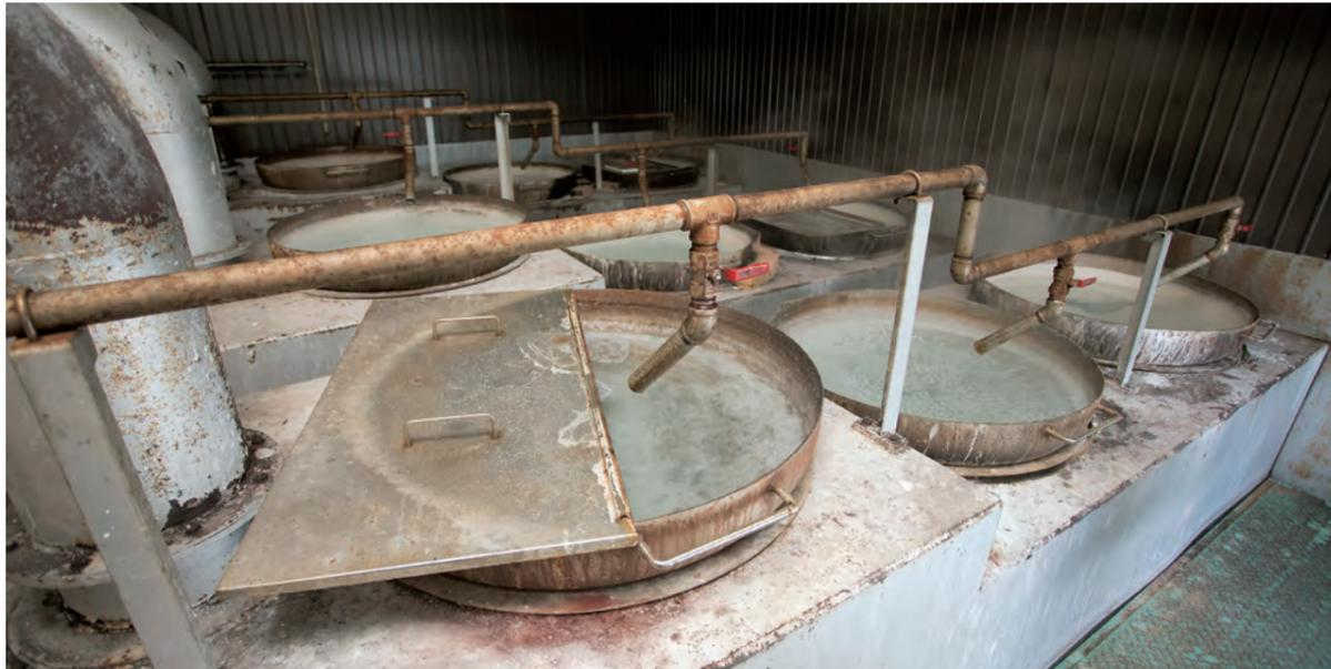
低温・緩速熟成製塩装置
