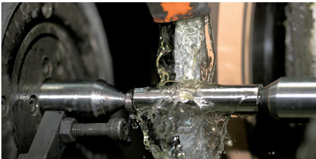
CNC万能研削盤による加工の様子
